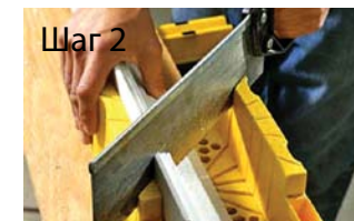
Шаг 2 Используя ножовку, вырезайте карниз под углом 45 градусов.
